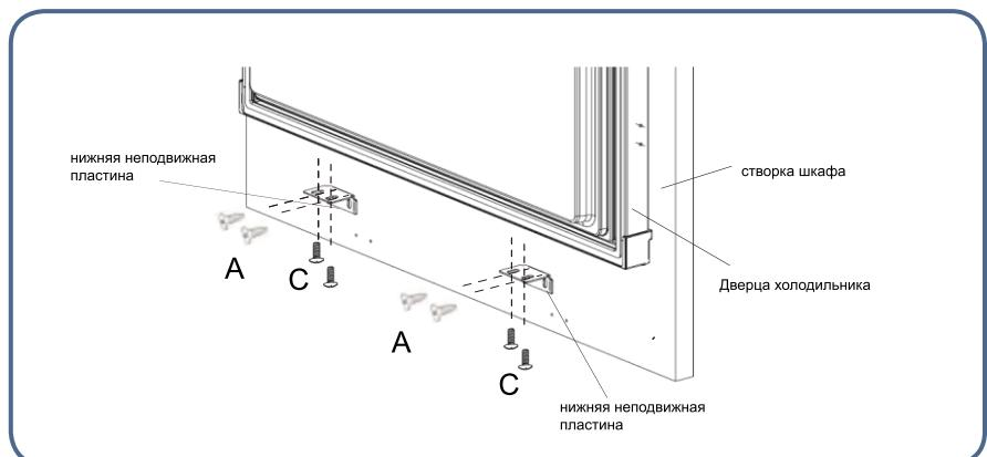
6. Процедура установки дверцы шкафа в дверь морозильного отделения аналогична процедуре установки дверцы шкафа в дверцу холодильного отделения.
