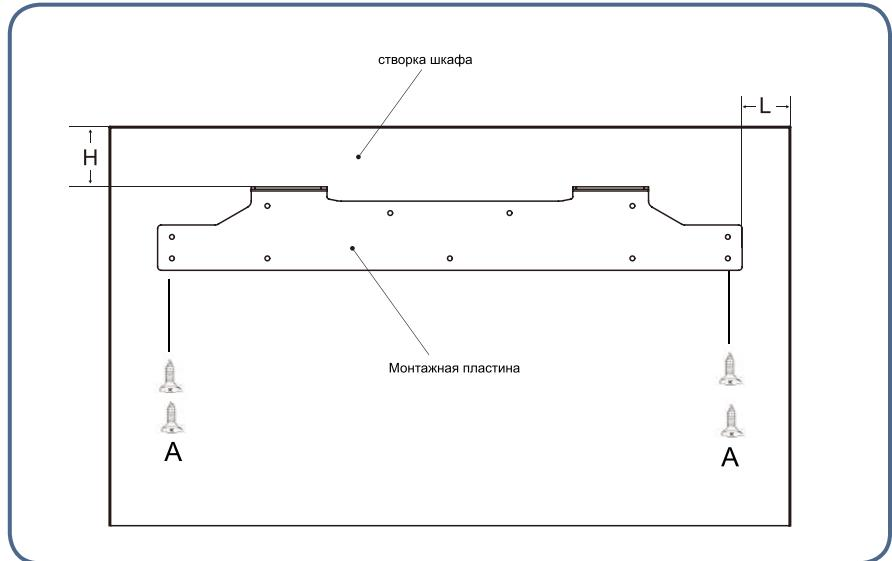
4. Прикрепите дверцу шкафа к дверце холодильного отделения с помощью монтажной пластины, затем затяните винты (не затягивайте винты слишком сильно, потому что их необходимо будет позже ослабить)
