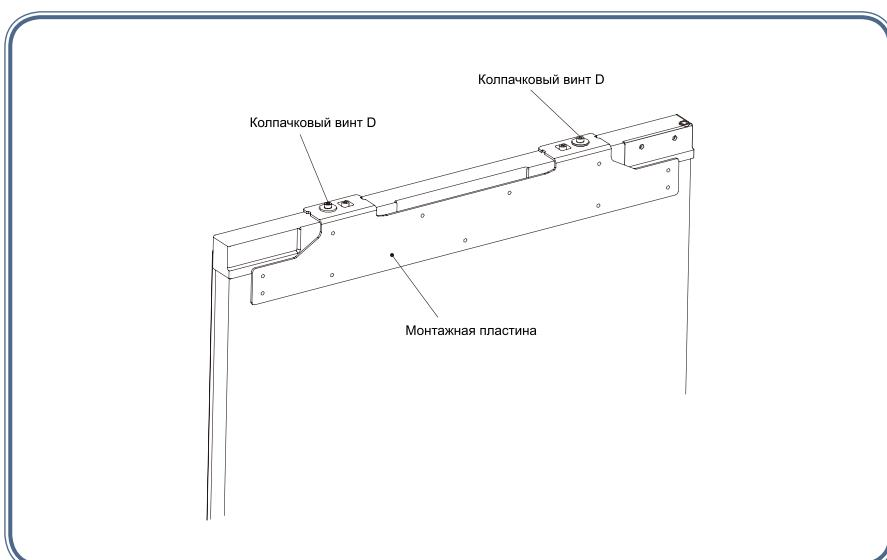
3. Измерьте и подтвердите положение, чтобы закрепить монтажную пластину на двери шкафа, а затем закрепите её винтами.
