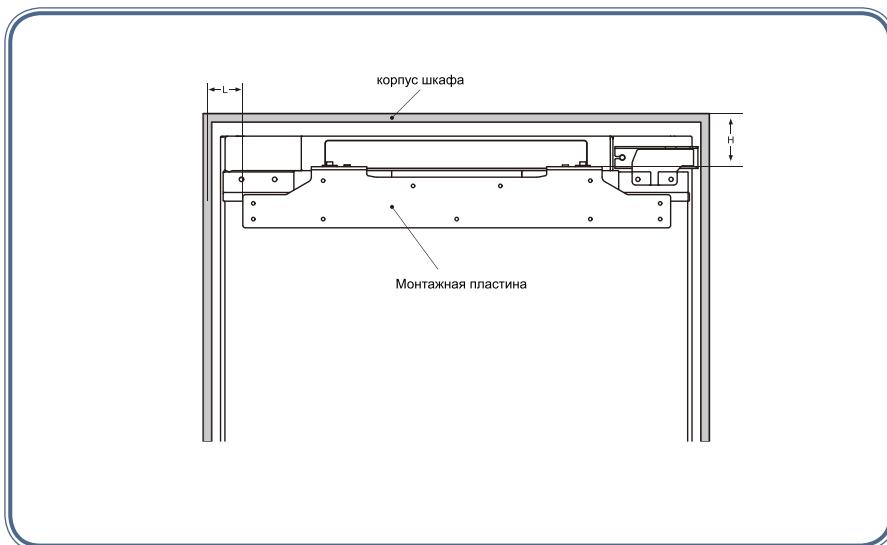
2. Ослабьте колпачковые винты крышки, затем снимите монтажную пластину.
