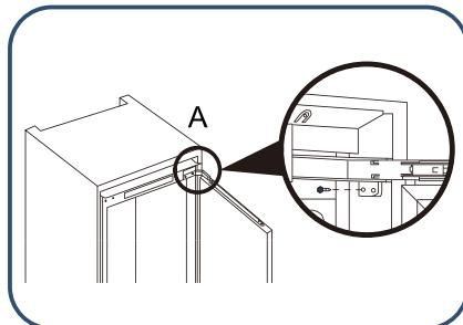
4. Поверните регулировочные ножки, чтобы холодильник и шкаф приняли правильное положение, а затем зафиксируйте регулировочные ножки винтами. Затем прикрутите верхнюю пластину холодильника к верхней части шкафа и закройте резьбовые заглушки.
